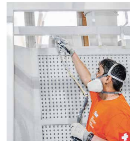
Rivestimento di superfici nella costruzione di finestre: specialisti ben formati danno un valore aggiunto all'artigianato.
