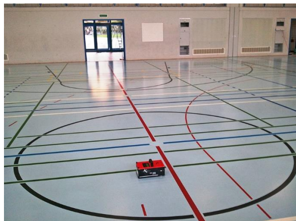
Abbildung 8 Messung des Gleitverhaltens mit einem mobilen Messgerät
