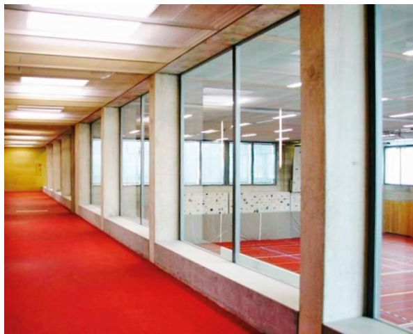
Abbildung 24 Einscheiben-Sicherheitsglas mit Kontraststreifen verhindert Verletzungen
