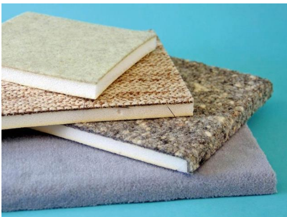
Abbildung 12 Prallschutz im Querschnitt
