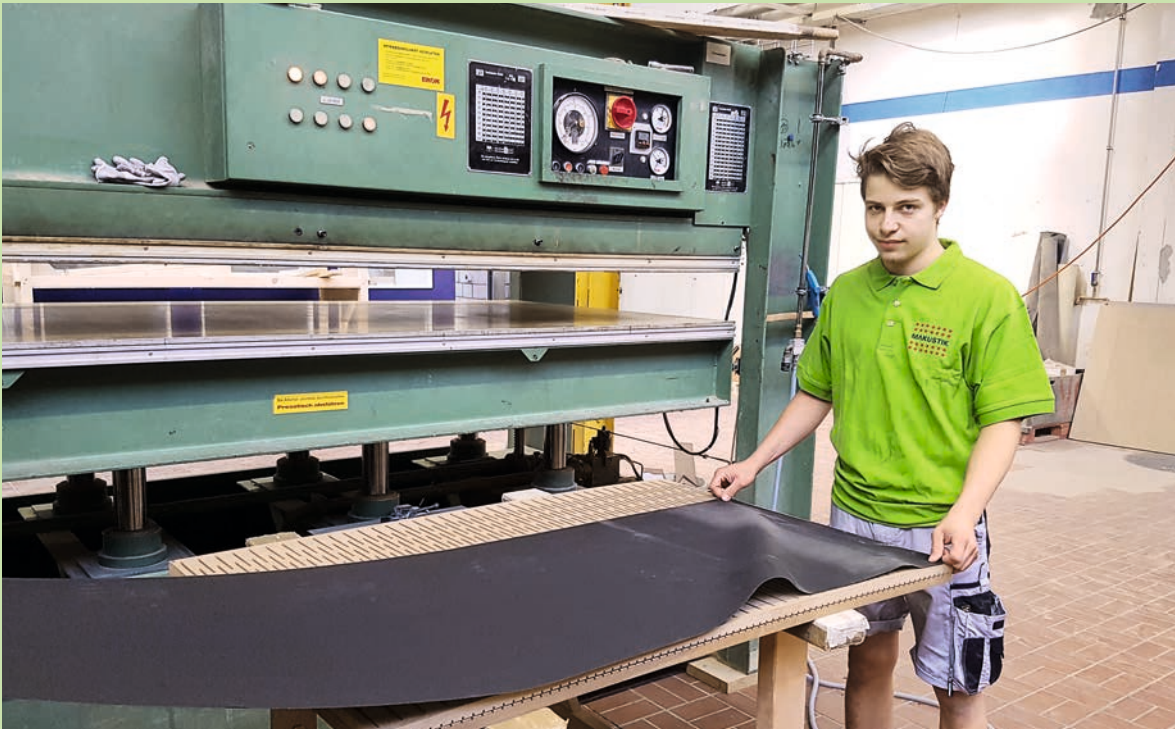
Jestin klebt Akustikvlies auf die Rückseite eines Akustikelements.
